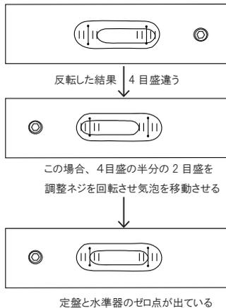
④水準器のゼロ点と定盤のゼロ点が出
