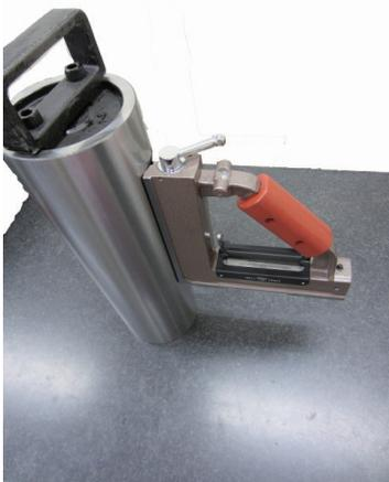
角形水準器の場合、測定対象に当ててみて、隙間があるかどうかで直角度を確認します。測定対象と角形水準器の間に隙間がある場合、直角ではないという事になります。
